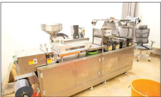
آلة صناعية كبيرة لتصنيع وتعبئة الكبسولات
