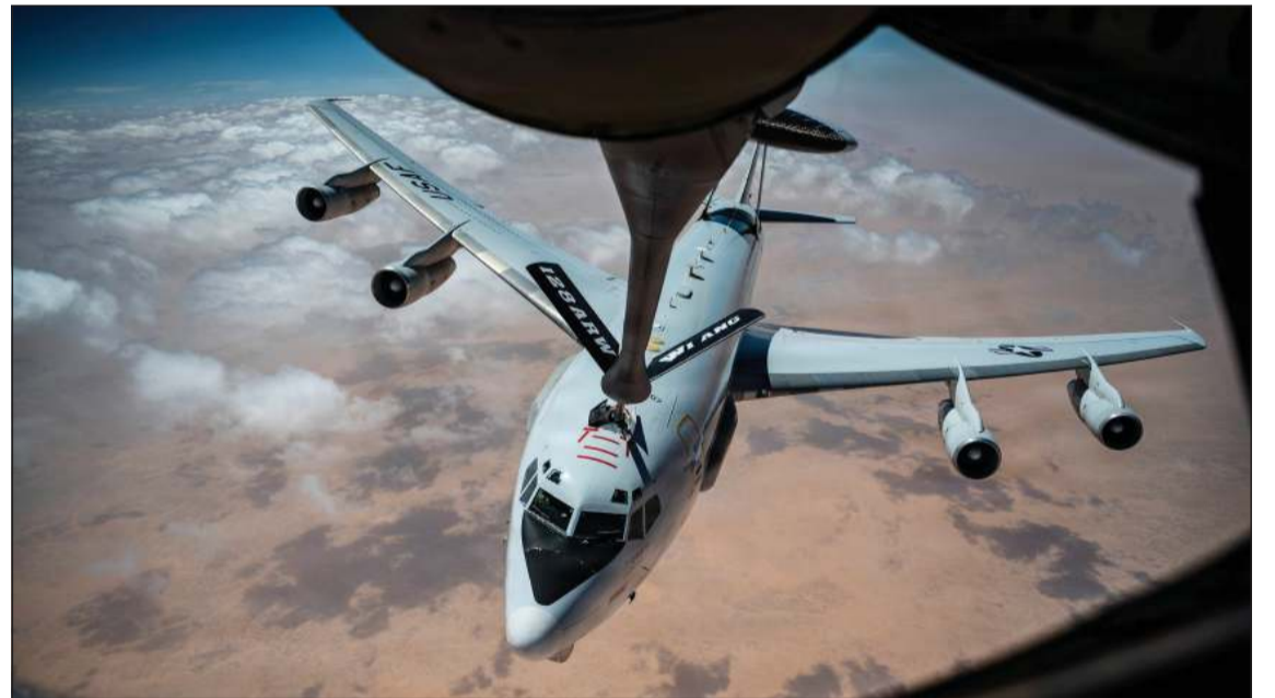
صورة نشرتها القيادة المركزية الأميركية لتزويد طائرة E-3 سنترى بالوقود جوا بواسطة طائرة KC-135 ستراوتونكر خلال مشاركتها في عملية الغضب للمحبي
