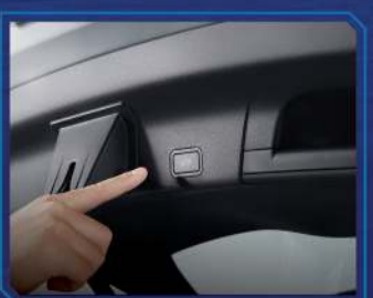
باب خلفي يعمل كهربائياً
