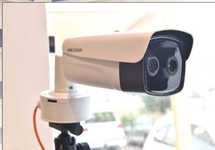
تثبيت كاميرات حرارية عند مدخل الفرع لقياس درجة حرارة العملاء قبل الدخول
