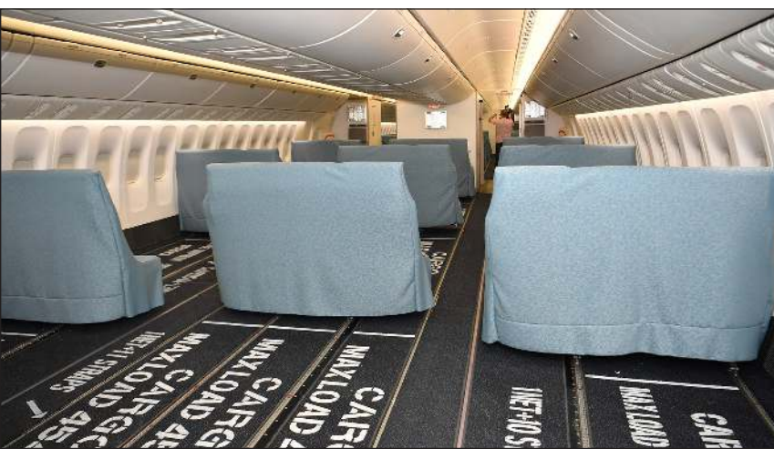
هكذا يبدو الشكل النهائي لكابينة الطائرة بالدرجة السياحية بعد إزالة المقاعد وتحويلها إلى حجرة شحن
