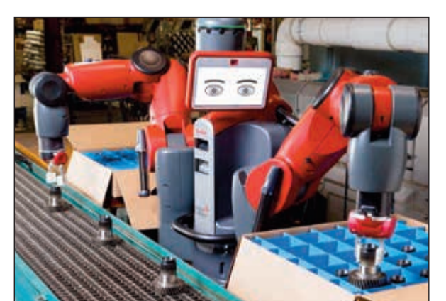
الروبوت باكستر للعمل في المصانع ولإداء المهام المتكررة بشكل دقيق
