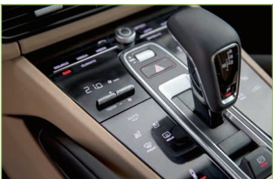
الكونسول الوسطي مزود بسطح ذي مظهر زجاجي يعمل باللمس مثل الهاتف الذكي يوفر رداً فعل صوتية ولمسية عند تنشيطه
