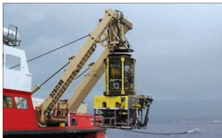
جهاز «ار او في» المحمل على بارجة «البرلس بي ام اس» الذي تحدث عنه السياسي ويمكنه كشف أعماق الجرار لمسافات تتراوح بين 2500 و 3000 متر سعياً للبحث عن الصندوقين الأسودين
