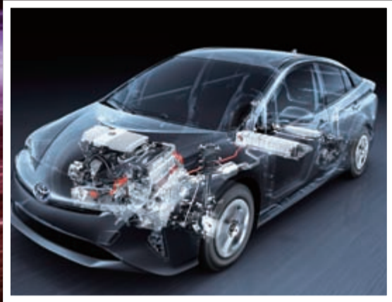
نظام الـ «هايبريد» في مركبة تويوتا «بريوس» يدمج محرك البنزين سعة 1.8 لتر مع المحرور الكهربائي
