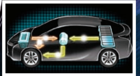
شاشة مراقبة الطاقة في مركبة تويوتا «بريوس» تعرض تدفق الطاقة في الوقت الفعلي ضمن نظام الـ «هايبريد»
