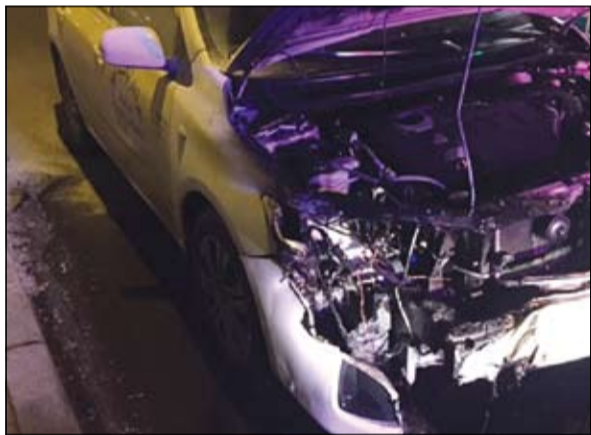
الجوال بعد إخماد الحريق الذي شب بمحركه
