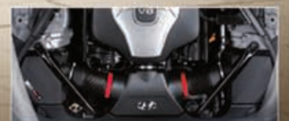
محرك GDI V6 سعة 3.8 لتر 315 حصان متوفر بمحرك GDI V8 سعة 5.0 لتر وبقوة 413 حصان
