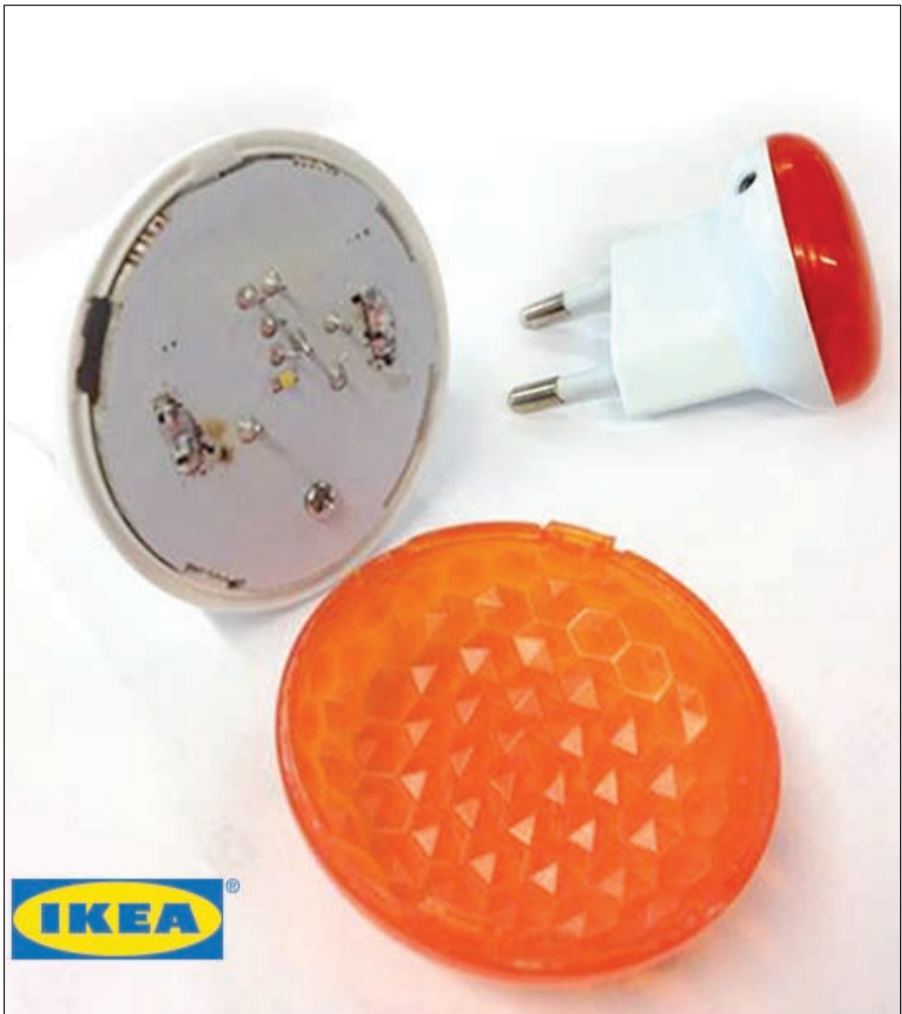
المثال يظهر مقبساً كهربائياً معمولاً به في الاتحاد الأوروبي لكن خطر وقوع حوادث محتملة هو نفسه بالنسبة لكل أنواع المقابس المعمول بها في مصباح PATRULL
