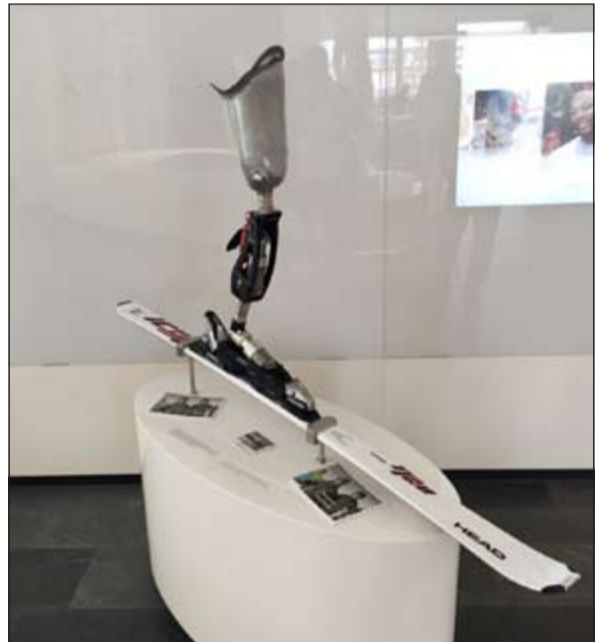
ساق صناعية حديثة يمكن استخدامها في رياضة التزلج على الجليد
