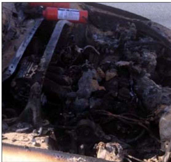
النيران أتلفت كامل محرك السيارة بسبب الدينامو المستعمل
