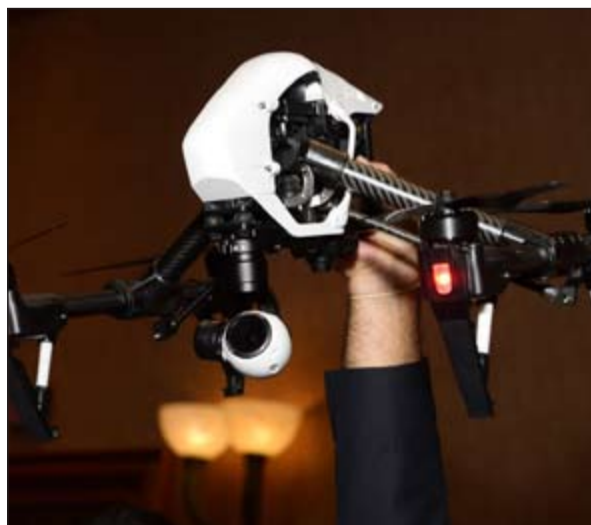
19 طائرة هليكوبتر يمكن أن تطير حتى 18 دقيقة مصنوعة منلياف الكربون لديها القدرة على الاقلاع والهبوط والدوران 360 درجة، مرتبطة بجهاز الكمبيوتر التي يمكن التحكم بها عن بعد. (أ.ف.ب)
