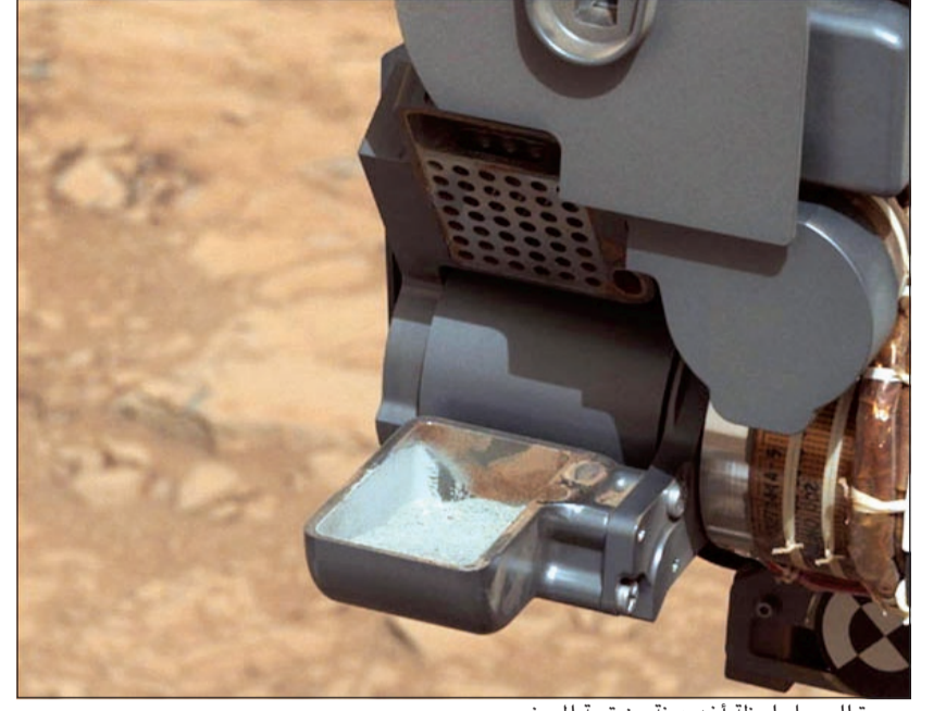
صورة للمسبار لحظة أخذ عينة من تربة المريخ
